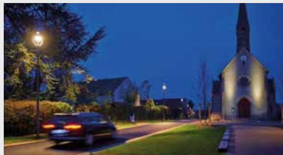
Les capteurs placés dans les candélabres permettent de faire des « trains de lumière » : ces derniers s'allument (ou passent en pleine puissance) à l'approche d'une voiture ou d'un piéton, pour revenir dans la foulée à leur état initial.
